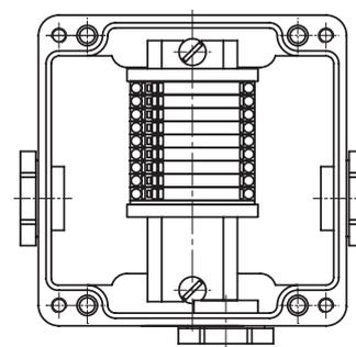
Коробка с пружинным клеммным блоком
